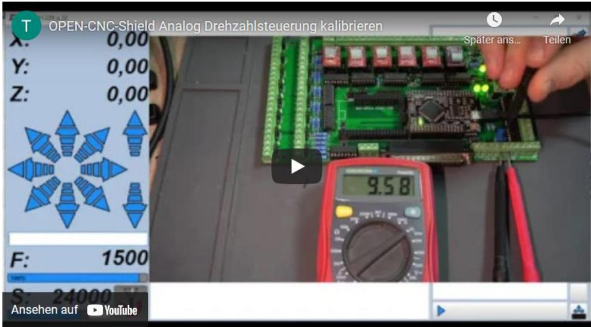
Film 2: Analoge Steuerung Drehzahlsteuerung kalibrieren
